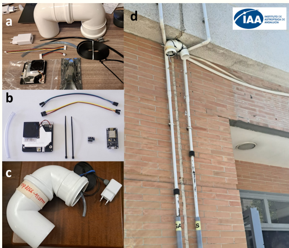
Figura 1. Configuración estática del equipo: (a) Kit con todos los accesorios necesarios (b) Sensor SDS (izquierda), sensor BME (centro, a la derecha de las dos bridas) y tarjeta NodeMCU (derecha). (c) Dispositivo ensamblado. (d) Dispositivo en su ubicación actual en el Instituto de Astrofísica. Se requiere una conexión WiFi y un enchufe cercano.
