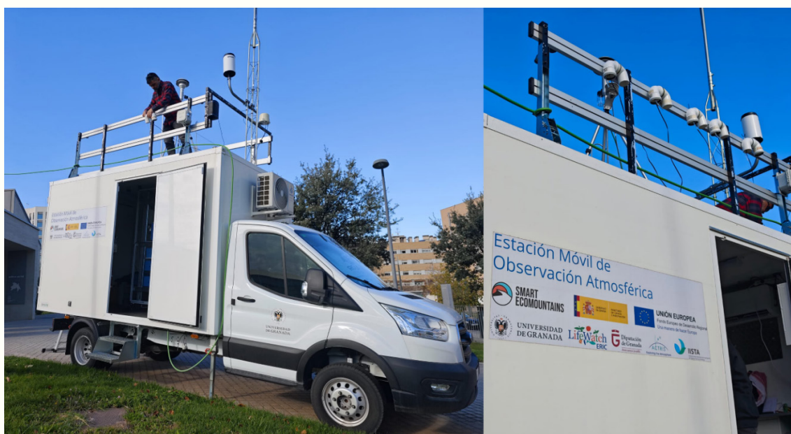
Figura 3. Calibración de los sensores en la unidad móvil del IISTA durante su estancia en la Biblioteca Biosanitaria-PTS (noviembre 2024).
